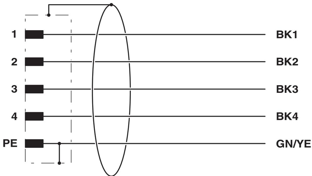
Kontaktbelegung des M12-Steckers
