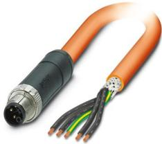
Powerleitung, 5-polig, PUR halogenfrei, orange RAL 2003, geschirmt (Advanced Shielding Technology), Stecker gerade M12, Kodierung: K, auf freies Leitungsende, Kabellänge: 1,5 m, für Wechselstrom bis 16 A/690 V
