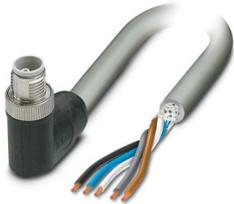
Powerleitung, 5-polig, PVC, grau RAL 7001, geschirmt (Advanced Shielding Technology), Stecker gewinkelt M12, Kodierung: L, auf freies Leitungsende, Kabellänge: 1,5 m, für Gleichstrom bis 16 A / 63 V
