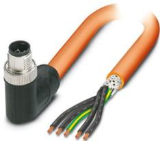
Powerleitung, 5-polig, PUR halogenfrei, orange RAL 2003, geschirmt (Advanced Shielding Technology), Stecker gewinkelt M12, Kodierung: K, auf freies Leitungsende, Kabellänge: 5 m, für Wechselstrom bis 16 A/690 V
