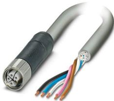
Powerleitung, 5-polig, PUR halogenfrei, grau RAL 7001, geschirmt (Advanced Shielding Technology), freies Leitungsende, auf Buchse gerade M12, Kodierung: L, Kabellänge: 5 m, für Gleichstrom bis 16 A / 63 V
