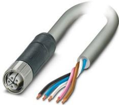
Powerleitung, 5-polig, PVC, grau RAL 7001, freies Leitungsende, auf Buchse gerade M12, Kodierung: L, Kabellänge: 3 m, für Gleichstrom bis 16 A / 63 V
