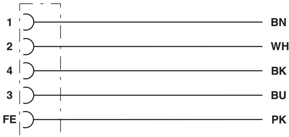
Kontaktbelegung der M12-Buchse
