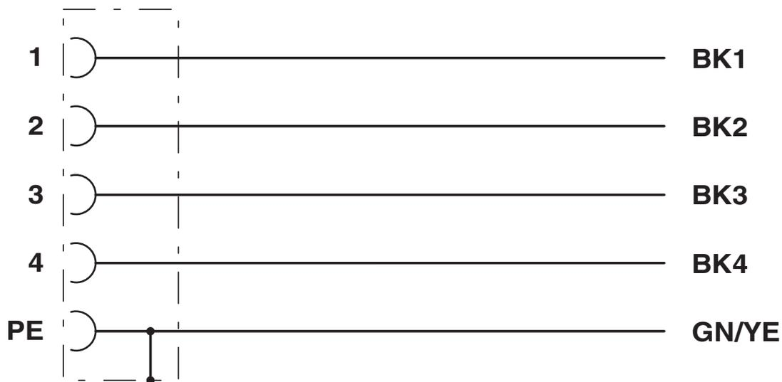
Kontaktbelegung der M12-Buchse
