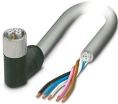
Powerleitung, 5-polig, PUR halogenfrei, grau RAL 7001, geschirmt (Advanced Shielding Technology), freies Leitungsende, auf Buchse gewinkelt M12, Kodierung: L, Kabellänge: 3 m, für Gleichstrom bis 16 A / 63 V
