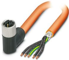
Powerleitung, 5-polig, PUR halogenfrei, orange RAL 2003, geschirmt (Advanced Shielding Technology), freies Leitungsende, auf Buchse gewinkelt M12, Kodierung: K, Kabellänge: 3 m, für Wechselstrom bis 16 A/690 V
