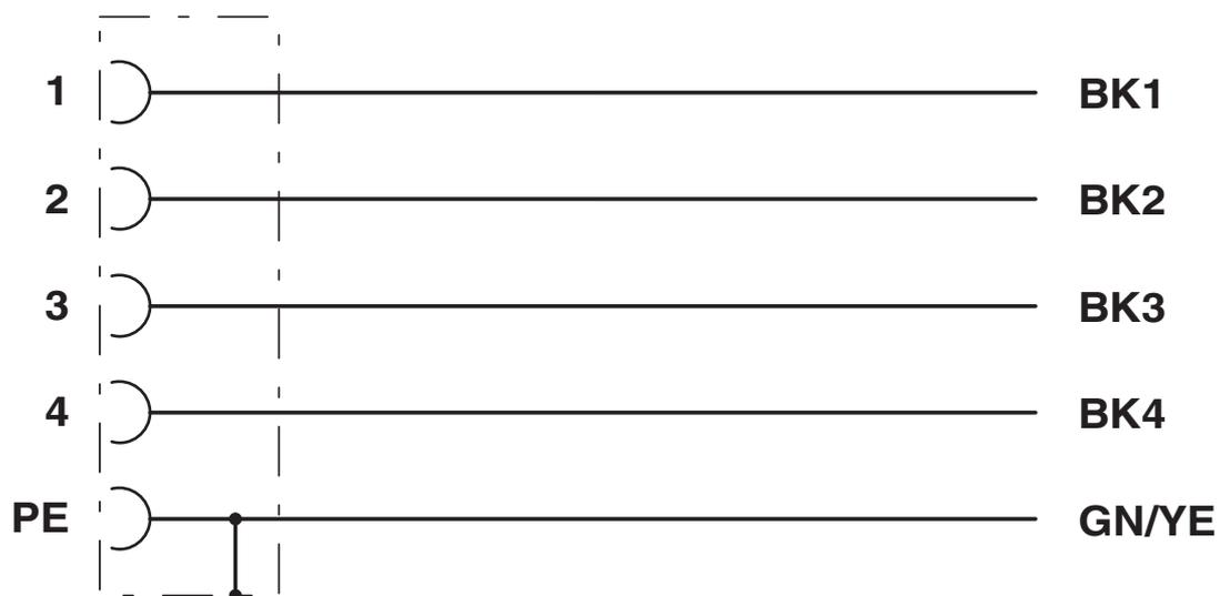
Kontaktbelegung der M12-Buchse
