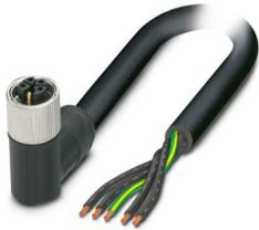
Powerleitung, 5-polig, PVC, schwarzgrau RAL 7021, freies Leitungsende, auf Buchse gewinkelt M12, Kodierung: K, Kabellänge: 1,5 m, für Wechselstrom bis 16 A/690 V
