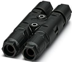
H-Verteiler, Anschlussart: IDC-Anschluss, Polzahl: 4+PE, 0,5 mm<sup>2</sup> ... 1,5 mm<sup>2</sup>, 690 V, 17,5 A, PA, schwarz, mit vier QUICKON-Muttern, Kodierung: Kodierprofil, Leitungsaußendurchmesser: 6 mm ... 10 mm, mit einem Verschlussbolzen
