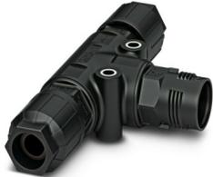
T-Verteiler, Anschlussart: IDC-Anschluss, Polzahl: 4+PE, 0,5 mm<sup>2</sup> ... 1,5 mm<sup>2</sup>, 690 V, 17,5 A, PA, schwarz, mit zwei QUICKKON-Muttern, Kodierung: Kodierprofil, Leitungsaußendurchmesser: 6 mm ... 10 mm
