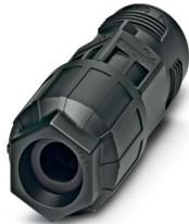
Leitungsverbinder, Anschlussart: IDC-Anschluss, Polzahl: 4+PE, 0,5 mm<sup>2</sup> ... 1,5 mm<sup>2</sup>, 690 V, 17,5 A, PA, schwarz, mit einer QUICKON-Mutter, Kodierung: Kodierprofil, Leitungsaußendurchmesser: 6 mm ... 10 mm
