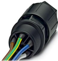
Wanddurchführung, Anschlussart: Einzeladern/ IDC-Anschluss, Polzahl: 4+PE, M25, Stift, 0,5 mm<sup>2</sup> ... 1,5 mm<sup>2</sup>, 690 V, 17,5 A, PA, schwarz, mit QUICKON-Mutter, Kodierung: Kodierprofil, Leitungsaußendurchmesser: 6 mm ... 10 mm, 1,5 mm<sup>2</sup>, Leitungslänge: 1 m
