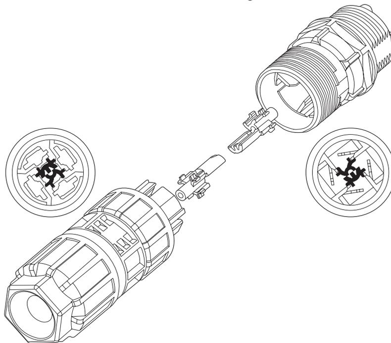
Kodierung der QUICKON-Steckverbindung
