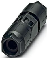
Leitungsverbinder, Anschlussart: IDC-Anschluss, Polzahl: 2+PE, 0,5 mm<sup>2</sup> ... 1,5 mm<sup>2</sup>, 690 V, 17,5 A, PA, schwarz, mit zwei QUICKON-Muttern, Kodierung: Kodierprofil, Leitungsaußendurchmesser: 5 mm ... 7 mm und 7 mm ... 9,5 mm
