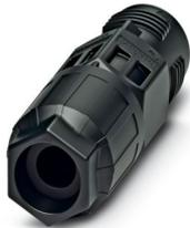
Leitungsverbinder, Anschlussart: IDC-Anschluss, Polzahl: 3+PE, 0,5 mm<sup>2</sup> ... 1,5 mm<sup>2</sup>, 690 V, 17,5 A, PA, schwarz, mit einer QUICKON-Mutter, Kodierung: Kodierprofil, Leitungsaußendurchmesser: 5 mm ... 7 mm und 7 mm ... 9,5 mm
