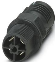
Wanddurchführung, Anschlussart: Flachsteckanschluss (für Flachsteckhülsen nach DIN 46247-2), Polzahl: 3+PE, M20, 0,5 mm<sup>2</sup> ... 1,5 mm<sup>2</sup>, 690 V, 17,5 A, PA, schwarz, ohne QUICKON-Mutter, Kodierung: Kodierprofil, 1,5 mm<sup>2</sup>
