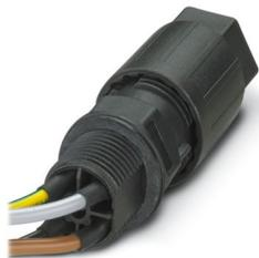
Wanddurchführung, Anschlussart: Einzeladern/ IDC-Anschluss, Polzahl: 3+PE, M20, Stift, 0,5 mm<sup>2</sup> ... 1,5 mm<sup>2</sup>, 690 V, 17,5 A, PA, schwarz, mit QUICKON-Mutter, Kodierung: Kodierprofil, Leitungsaußendurchmesser: 5 mm ... 7 mm und 7 mm ... 9,5 mm, 1,5 mm<sup>2</sup>, Leitungslänge: 0,5 m
