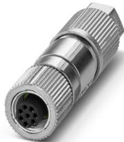
Steckverbinder, Universal, 8-polig, halogenfrei, geschirmt, Buchse gerade M12, Kodierung: A, Schneidklemmanschluss, Rändelmaterial: Zinkdruckguss, vernickelt, Leitungsaußendurchmesser 5 mm ... 9,7 mm
