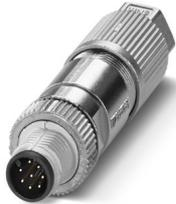
Steckverbinder, Universal, 8-polig, halogenfrei, geschirmt, Stecker gerade M12, Kodierung: A, Schneidklemmanschluss, Rändelmaterial: Zinkdruckguss, vernickelt, Leitungsaußendurchmesser 5 mm ... 9,7 mm
