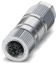
Datensteckverbinder, PROFINET CAT6<sub>A</sub> (10 GBit/s), 8-polig, halogenfrei, geschirmt, Buchse gerade M12, Kodierung: X, Schneidklemmanschluss, Rändelmaterial: Zinkdruckguss, vernickelt, Leitungsaußendurchmesser 5 mm ... 9,7 mm
