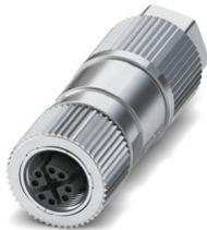
Datensteckverbinder, Ethernet CAT6<sub>A</sub> (10 GBit/s), 8-polig, halogenfrei, geschirmt, Buchse gerade M12, Kodierung: X, Schneidklemmanschluss, Rändelmaterial: Zinkdruckguss, vernickelt, Leitungsaußendurchmesser 5 mm ... 9,7 mm
