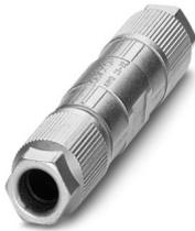
Leitungsverbinder, PROFINET CAT6<sub>A</sub> (10 GBit/s), 8-polig, halogenfrei, geschirmt, Schneidklemmanschluss, Gehäusematerial: Zinkdruckguss, vernickelt, Kabelaußendurchmesser 5 mm ... 9,7 mm
