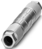
Leitungsverbinder, Ethernet CAT6<sub>A</sub> (10 GBit/s), 8-polig, halogenfrei, geschirmt, Schneidklemmanschluss, Gehäusematerial: Zinkdruckguss, vernickelt, Kabelaußendurchmesser 5 mm ... 9,7 mm
