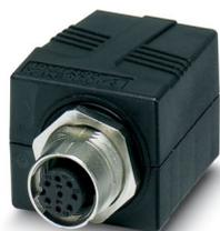
Schaltschrankdurchführung, M12, 8-polig, A-kodiert auf RJ45-Buchse, Buchseneingang 180°, IP65/67
