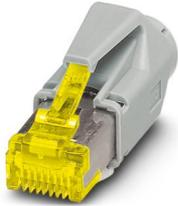
RJ45-Steckverbinder, Bauform: RJ45, Schutzart: IP20, Polzahl: 8, 10 GBit/s, CAT6<sub>A</sub>, Material: Kunststoff, Anschlussart: Crimpanschluss, Anschlussquerschnitt: AWG 24- 27, Kabelabgang: gerade, Farbe: grau, Ethernet
