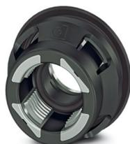
M12-Gehäuseverschraubung mit toleranzausgleichender Funktion, für gerade, THR-fähige M12-Buchsenkontakteinsätze. Geeignet für Frontplattenwandstärken von 2,4 mm ... 3,2 mm.
