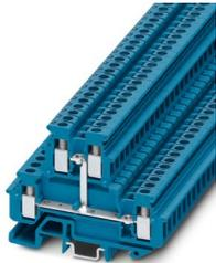
Minidurchgangsklemme, mit Potenzialverbinder, Nennspannung: 500 V, Nennstrom: 24 A, Anschlussart: Schraubanschluss, 1. und 2. Etage, Bemessungsquerschnitt: 2,5 mm<sup>2</sup>, Querschnitt: 0,2 mm<sup>2</sup> - 4 mm<sup>2</sup>, Montageart: NS 15, NS 35/7,5, NS 35/15, Farbe: blau
