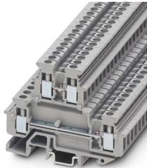
Minidurchgangsklemme, Nennspannung: 500 V, Nennstrom: 24 A, Anschlussart: Schraubanschluss, 1. und 2. Etage, Bemessungsquerschnitt: 2,5 mm<sup>2</sup>, Querschnitt: 0,2 mm<sup>2</sup> - 4 mm<sup>2</sup>, Montageart: NS 15, NS 35/7,5, NS 35/15, Farbe: grau
