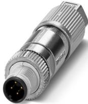
Steckverbinder, Universal, 4-polig, halogenfrei, geschirmt, Stecker gerade M12, Kodierung: A, Schneidklemmanschluss, Rändelmaterial: Zinkdruckguss, vernickelt, Leitungsaußendurchmesser 5 mm ... 9,7 mm
