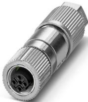
Datensteckverbinder, PROFIBUS (12 MBit/s), 2-polig, halogenfrei, geschirmt, Buchse gerade M12, Kodierung: B, Schneidklemmanschluss, Rändelmaterial: Zinkdruckguss, vernickelt, Leitungsaußendurchmesser 5 mm ... 9,7 mm
