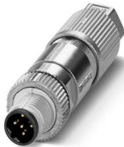
Datensteckverbinder, PROFIBUS (12 MBit/s), 2-polig, halogenfrei, geschirmt, Stecker gerade M12, Kodierung: B, Schneidklemmanschluss, Rändelmaterial: Zinkdruckguss, vernickelt, Leitungsaußendurchmesser 5 mm ... 9,7 mm
