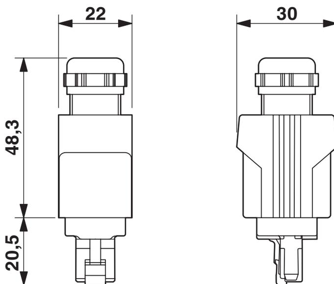
Push-Pull RJ45-Steckverbinder IP65/67
