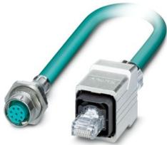
Konfektioniertes Ethernet-Kabel, geschirmt, 4-paarig, AWG 26 schleppkettentauglich (19-drähtig), RAL 5021 (wasserblau), M12-Einbaubuchse, Hinterwand-/Schraubmontage mit M16-Gewinde auf RJ45-Stecker/IP67 Push-Pull Metallgehäuse, Line, Länge 2 m
