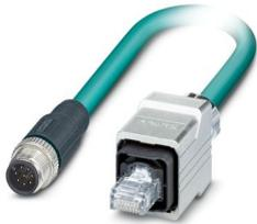
Netzwerkkabel, Ethernet CAT5 (1 GBit/s), 8-polig, PUR halogenfrei, wasserblau RAL 5021, Stecker gerade M12, Kodierung: A / IP67, auf Stecker gerade RJ45 Push-Pull / IP67, Kabellänge: 2 m
