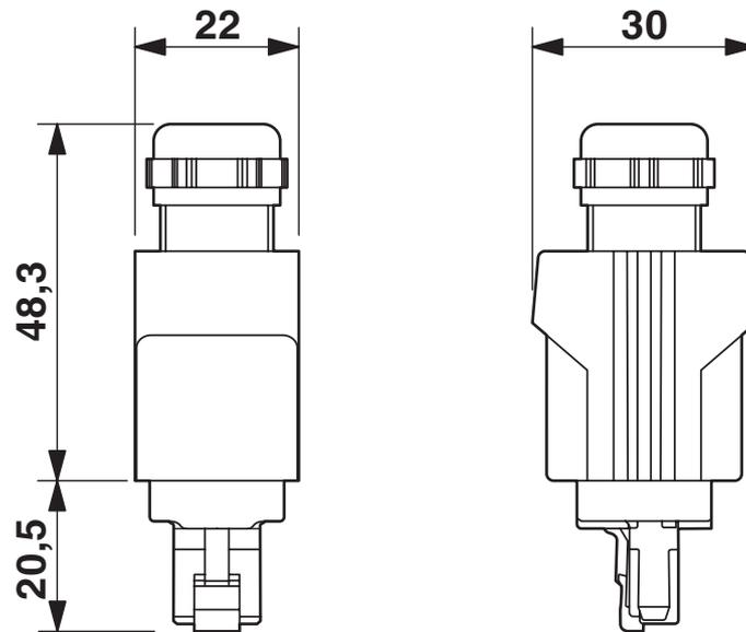
Push-Pull RJ45-Steckverbinder IP65/67
