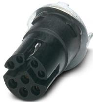
Kontaktträger, Ethernet CAT5 (IEC 11801:2002), 8-polig, Buchse, gerade, M12, Y-Kodierung, THR-Lötanschluss, dieser Artikel ist voraussichtlich ab 2026-Q1 nach RoHS II ohne Ausnahme 6c (Pb < 0,1 %) bleifrei, auf Anfrage ist eine bleifreie Alternative vorab möglich
