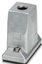
HEAVYCON ADVANCE-Tüllengehäuse, B10, mit Schraubverriegelung (Innensechskant) aus Edelstahl, seewasserbeständiges Aluminium, Höhe 93,7 mm, mit Gewinde 1x M32, geradem Kabelabgang, ohne Oberfläche; leitfähige Dichtung (EMV-Eigenschaften)
