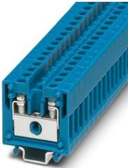
Minidurchgangsklemme, Nennspannung: 500 V, Nennstrom: 24 A, Anzahl der Anschlüsse: 2, Anschlussart: Schraubanschluss, Bemessungsquerschnitt: 2,5 mm<sup>2</sup>, 1. Etage, Querschnitt: 0,2 mm<sup>2</sup> - 4 mm<sup>2</sup>, Montageart: NS 15, Farbe: blau
