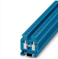
Minidurchgangsklemme, Nennspannung: 500 V, Nennstrom: 24 A, Anzahl der Anschlüsse: 2, Anschlussart: Schraubanschluss, Bemessungsquerschnitt: 2,5 mm<sup>2</sup>, Querschnitt: 0,2 mm<sup>2</sup> - 4 mm<sup>2</sup>, Montageart: NS 15, Farbe: blau
