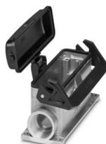
Sockelgehäuse B24, mit Längsbügel, Material: Aluminiumdruckguss, seewasserbeständig, Material Schutzdeckel: PC, Kabelabgänge: 2, seitlich, 2x Pg21, Höhe: 68 mm, Kabelverschraubung: ohne, Schutzdeckel: ja, Standard
