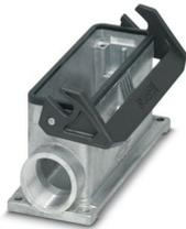
Sockelgehäuse B24, mit Längsbügel, Material: Aluminiumdruckguss, seewasserbeständig, Kabelabgänge: 2, seitlich, 2x M32, Höhe: 68 mm, Kabelverschraubung: ohne, Standard
