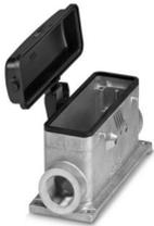
Sockelgehäuse B24, für Querbügel, Material: Aluminiumdruckguss, seewasserbeständig, Material Schutzdeckel: PC, Kabelabgänge: 2, seitlich, 2x M32, Höhe: 68 mm, Kabelverschraubung: ohne, Schutzdeckel: ja, Standard
