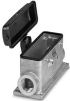
Sockelgehäuse B24, für Querbügel, Material: Aluminiumdruckguss, seewasserbeständig, Material Schutzdeckel: PC, Kabelabgänge: 2, seitlich, 2x M25, Höhe: 68 mm, Kabelverschraubung: ohne, Schutzdeckel: ja, Standard
