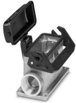
Sockelgehäuse B16, mit Längsbügel, Material: Aluminiumdruckguss, seewasserbeständig, Material Schutzdeckel: PC, Kabelabgänge: 2, seitlich, 2x Pg21, Höhe: 68 mm, Kabelverschraubung: ohne, Schutzdeckel: ja, Standard
