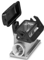
Sockelgehäuse B16, mit Längsbügel, Material: Aluminiumdruckguss, seewasserbeständig, Material Schutzdeckel: PC, Kabelabgänge: 2, seitlich, 2x M32, Höhe: 68 mm, Kabelverschraubung: ohne, Schutzdeckel: ja, Standard
