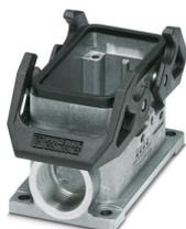
Sockelgehäuse B10, mit Querbügel, Material: Aluminiumdruckguss, seewasserbeständig, Kabelabgänge: 2, seitlich, 2x Pg16, Höhe: 54 mm, Kabelverschraubung: ohne, Standard
