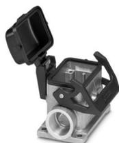
Sockelgehäuse B6, mit Längsbügel, Material: Aluminiumdruckguss, seewasserbeständig, Material Schutzdeckel: PC, Kabelabgänge: 2, seitlich, 2x M20, Höhe: 54,6 mm, Kabelverschraubung: ohne, Schutzdeckel: ja, Standard
