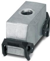
Tüllengehäuse B24, mit Querbügel, Material: Aluminiumdruckguss, seewasserbeständig, Kabelabgänge: 1, gerade, 1x Pg29, Höhe: 60 mm, Kabelverschraubung: ohne, Standard
