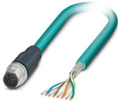
Netzwerkkabel, Ethernet CAT5 (1 GBit/s), 8-polig, PUR halogenfrei, wasserblau RAL 5021, Stecker gerade M12, Kodierung: A / IP67, auf freies Leitungsende, Kabellänge: 2 m
