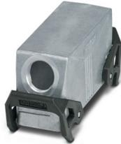
Tüllengehäuse B24, mit Querbügel, Material: Aluminiumdruckguss, seewasserbeständig, Kabelabgänge: 1, seitlich, 1x M25, Höhe: 60 mm, Kabelverschraubung: ohne, Standard
